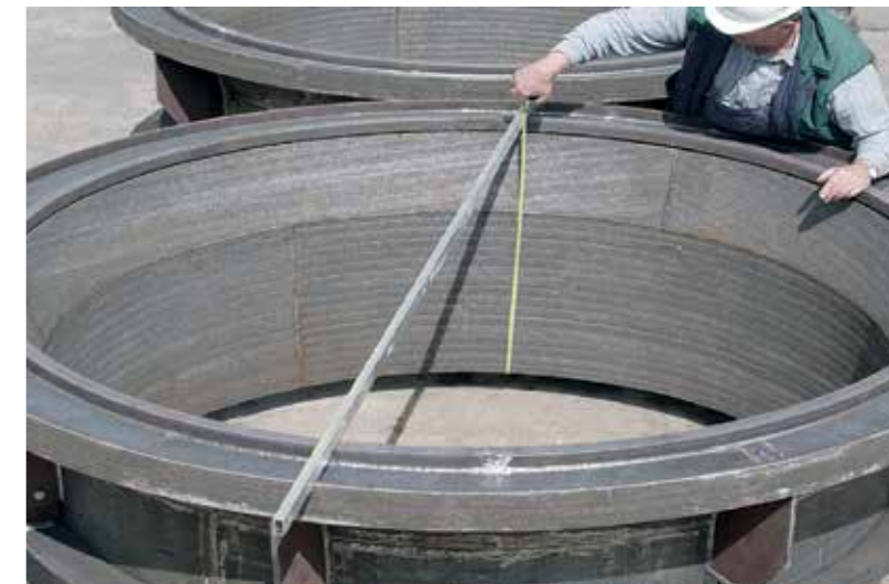
Cones de separação de separadores de cimento em KALMETALL W100 6 + 4, diâmetro de 3.000 mm
