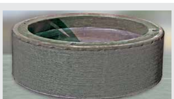
ABRESIST como revestimento do tubo de descarga intermediária de um moinho de bolas
