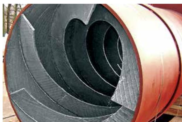
Rosca transportadora para alimentação de moinho, protegida com KALMETALL W100, diâmetro de 1.350 mm, espessura de revestimento de 5 ou 8 mm, estrutura autoportante.
