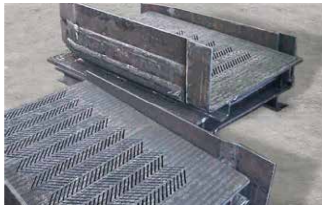
As peneiras são utilizadas em diversas áreas do processamento de matérias primas. O padrão de espinha de peixe é gravado na chapa soldada por deposição KALMETALL.
