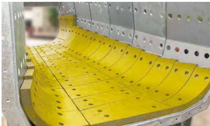
Proteção segura de uma calha de material com placas de metal duro fundido de 62 mm KALCAST 155 e revestimento de borracha de 8 mm, para melhor proteção contra impacto e ruídos.
