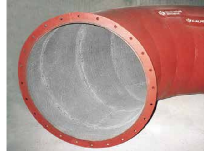
Em casos onde há alta sobrecarga devido a impacto, paredes de baixa espessura ou peso limitado, os componentes de tubos são fabricados com chapas de solda dura por deposição KALMETALL.
