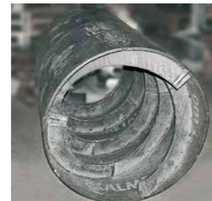
As pás da rosca transportadora da entrada do moinho são reforçadas dos dois lados com KALMETALL W100, diâmetro de 800 mm.
