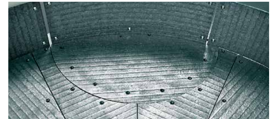
Revestimento interno de um misturador, as paredes laterais, o piso e os elementos de descarga são protegidos com KALMETALL W100, com diâmetro de 3.500 mm.
