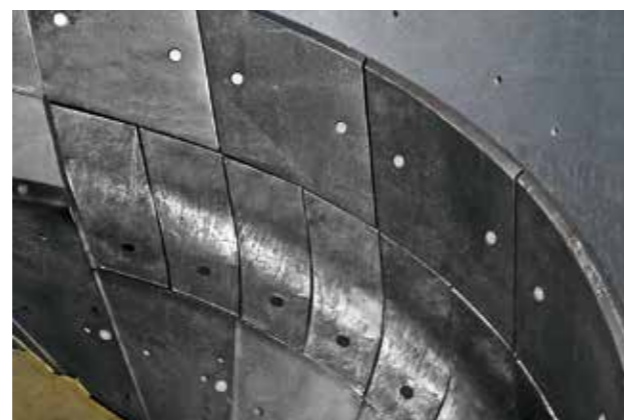
As peneiras são utilizadas em diversas áreas do processamento de matérias primas. O padrão de espinha de peixe é gravado na chapa soldada por deposição KALMETALL.
