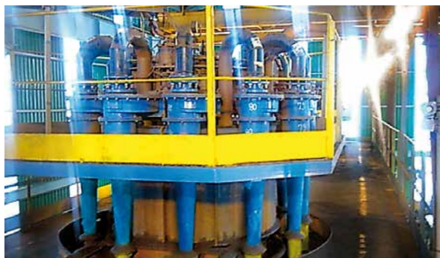
A proteção correta para hidrociclones prolonga a vida útil e reduz os custos relacionados a tempo ocioso
