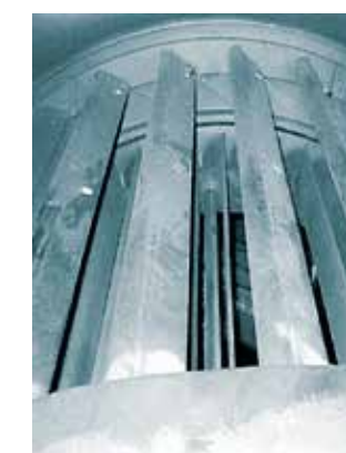
Estrutura com peso reduzido de uma gaiola de separação com cerâmica de carboneto de silício KALSICA A; Opções alternativas através da utilização de KALMETALL e pastilhas de KALOCER
