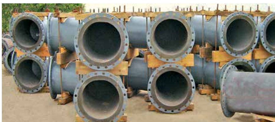
Tempo de operação prolongado a custos reduzidos com o metal duro fundido KALCAST; o exemplo mostra tubos com diâmetro de 518 mm e pesos até 700 kg
