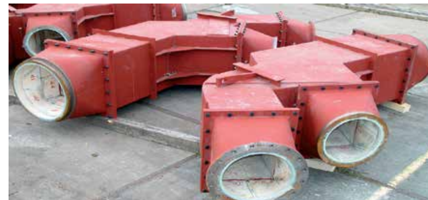
Caixas de distribuição de carvão em pó protegidas com KALCOR para revestimento de grande área e KALOCER para a mais alta resistência ao desgaste
