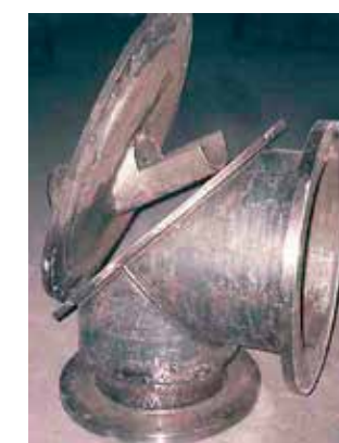
Queimador de carvão em pó feito de placas soldadas por deposição dura de KALMETALL W100 pronto para a instalação
