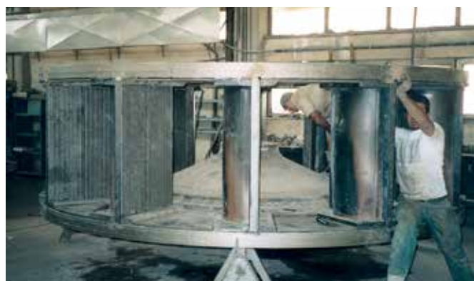
Os moinhos de roda de impacto são utilizados em usinas de energia; as placas da roda de impacto são reforçadas com KALMETALL W100
