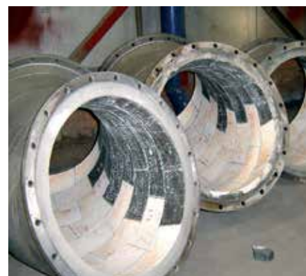
A economia ideal através da combinação de materiais; neste caso, KALCOR e ABRESIST
