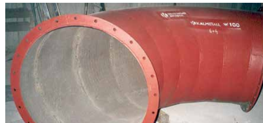
Nas curvas para carvão em pó, a solda dura por deposição KALMETALL permite obter estruturas autoportantes sem revestimento adicional
