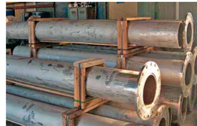
Tubos em Kalmetall W151, Ø 355 mm. Material base de 12,8 mm.
