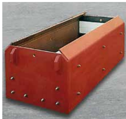
Caixa de frenagem na granulação de escória; a estrutura em KALMETALL é reforçada com KALOCER na área de maior desgaste
