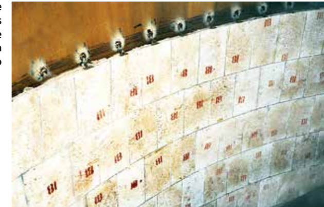
Para realizar o revestimento de um ciclone em pouco tempo, utiliza-se o revestimento combinado de composto duro KALCRET BTS e zircônio corundum KALCOR. O rendimento de aplicação de KALCRET BTS é de até 5 m 2 /h
