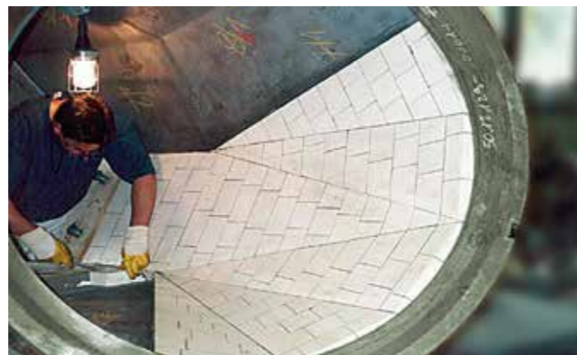
Funil octogonal com revestimento KALOCER; as peças moldadas de 50 mm são cortadas tridimensionalmente, para um encaixe ideal
