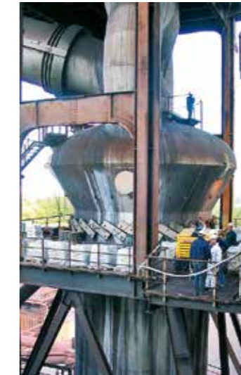
Para realizar o revestimento de um ciclone em pouco tempo, utiliza-se o revestimento combinado de composto duro KALCRET BTS e zircônio corundum KALCOR. O rendimento de aplicação de KALCRET BTS é de até 5 m 2 /h
