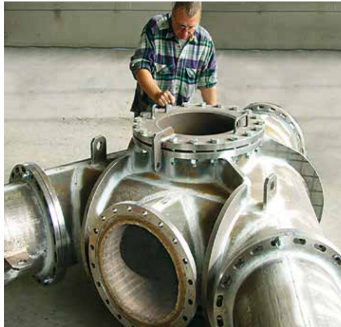
Tubo de equalização de pressão no alto-forno; estrutura autoportante em solda dura por deposição KALMETALL W100 30 + 6; 450 mm Ø
