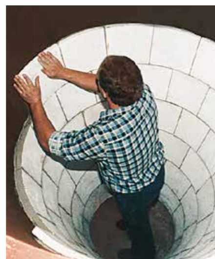
Peças em zircônio corundum KALCOR precisamente moldadas garantem proteção contra desgaste no cone de um coletor de pó, mesmo em altas temperaturas e choques térmicos
